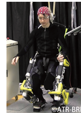
脳信号を判別し外骨格ロボットを動かす
